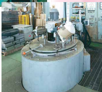
ガス軟室化処理炉
